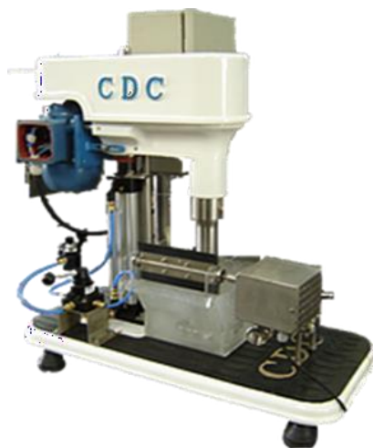
Figura 1. Célula de Flotação da CDC modelo CFB-1000-EEPN ( Manual do fornecedor, 2015 ).
