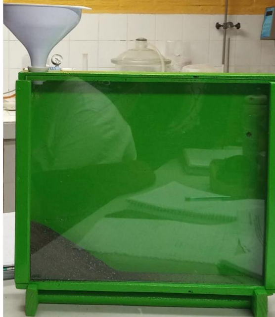
Figura 2. Equipamento para determinação de ângulo de repouso de materiais particulados ANGLER.
