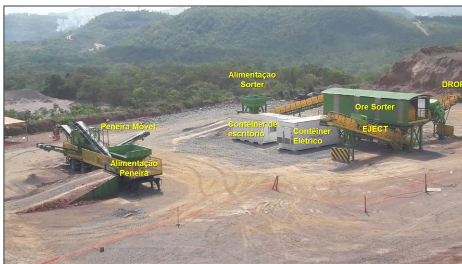
Figura 4 - Foto da área de instalação da peneira móvel e do Ore Sorter na unidade Vazante/MG
