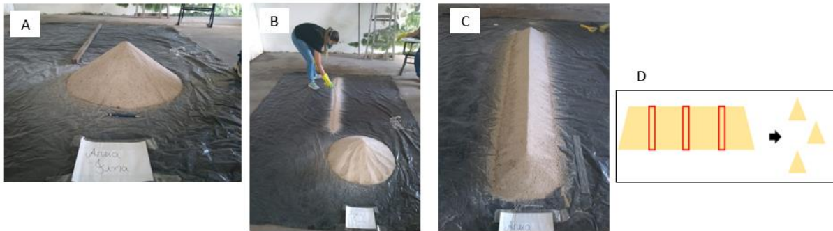
Figura 1. Homogeneização e quartejamento da amostra de areia. A) Pilha cônica B) Formação da pilha alongada C) Pilha alongada D) Posições na pilha alongada onde ocorreram as retiradas das alíquotas.
