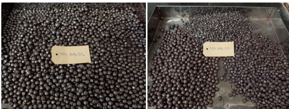
Figura 5. Foto dos corpos moedores com reposição de (a) bolas novas e (b) bolas reutilizadas
