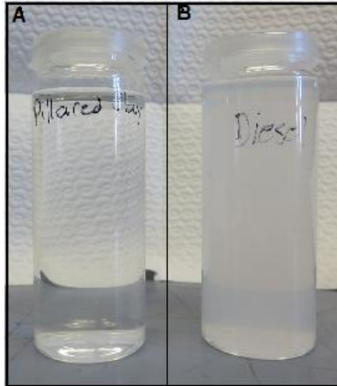
Figura 5: A. filtrado obtido processo de adsorção com argila organofílica; B. emulsão diesel-água 500ppm
