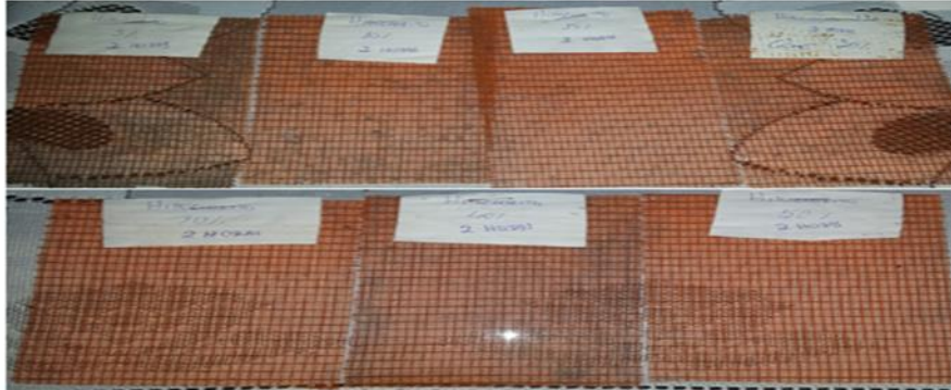
Figura 3. Telas tratadas com hipoclorito de sódio. Na parte superior, telas tratadas nas concentrações de 5; 10; 15 e 20%. Na parte inferior as telas tratadas com 30; 40 e 50% v/v com duas horas de imersão.
