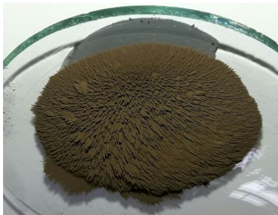
Figura 1. Ferrita exposta a um campo magnético externo.
