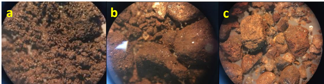
Figura 4. (a) Imagem da alimentação do peneiramento da condição 6 antes da desagregação preliminar (4x). (b) Imagem do material retido no 1º estágio do peneiramento da condição 6 (4x). (c) Imagem do material retido no 2º estágio do peneiramento da condição 6 (4x).
