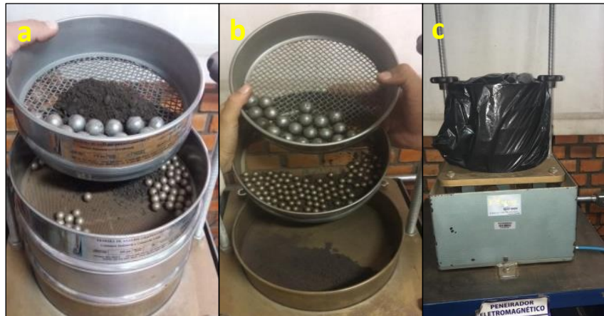
Figura 3. (a) Imagem antes da desagregação preliminar com tela de 4,75mm. (b) Imagem depois da desagregação preliminar com tela de 4,75mm. (c) Enclausuramento do sistema no peneiramento em 0,15mm.
