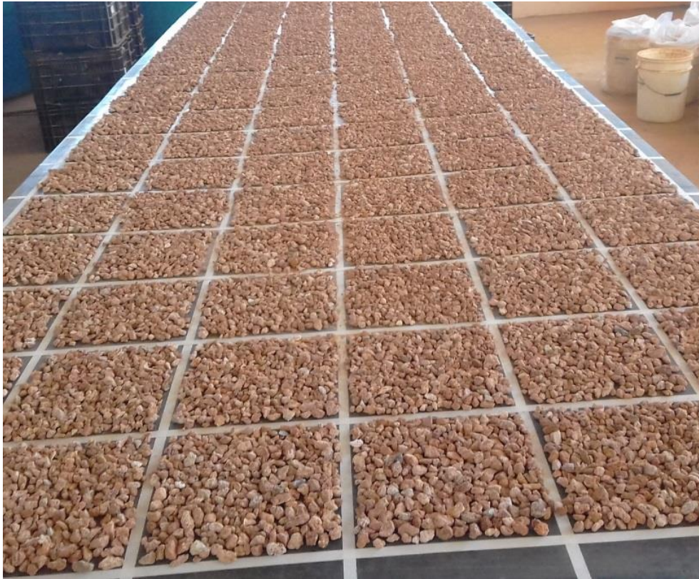
Figura 1. Matriz de 300 x 300 mm com os fragmentos dentro da faixa granulométrica -25,4 + 12,7 mm
